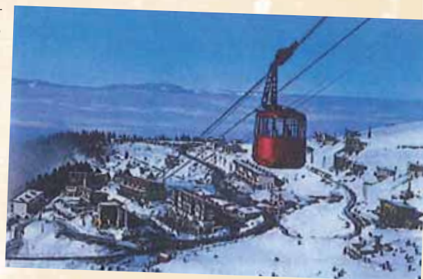
Le téléphérique conçu par la société Neyret-Beylier en 1952, d'une longueur de 2 000 mètres et d'une dénivellation de 600 mètres. Les câbles reposent sur quatre pylônes dont le plus grand atteint un peu plus de 50 m.
